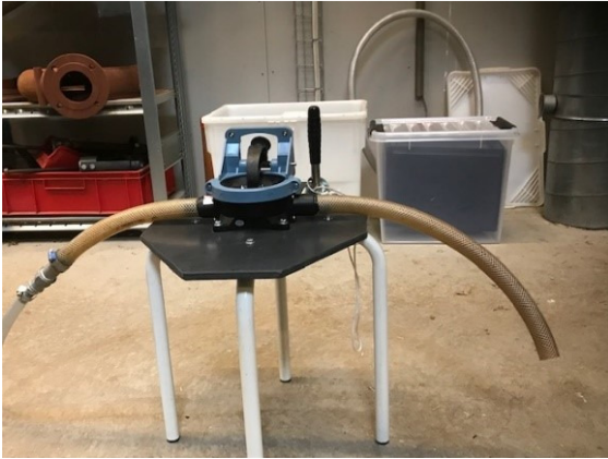
Figur 20: Pumpe til prøvetagning fra gyllekanaler.
