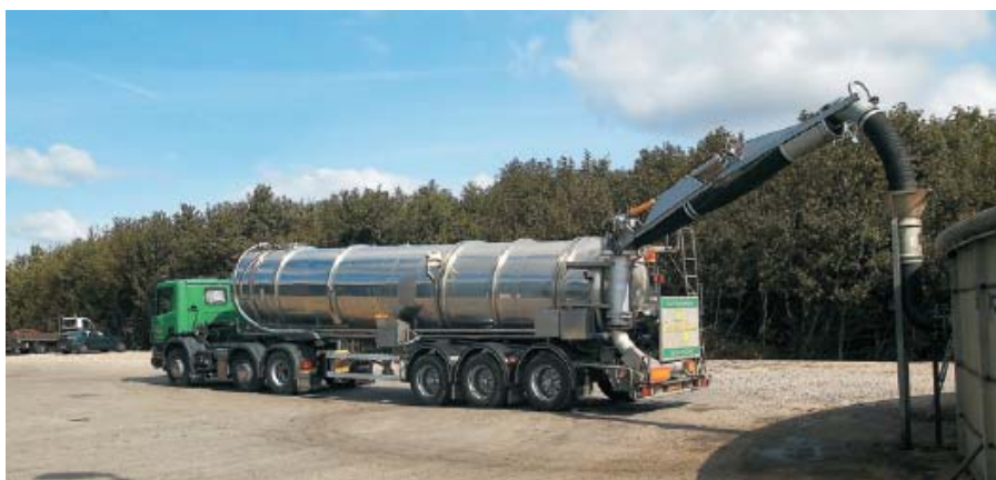
Fig. 2.2.: 33 t gyllelastbil til transport af rå og afgasset gylle fra biogasanlæg. Bemærk aflæsestuds på lagertanken. Det samme system anvendes på biogasanlægget til aflæsning og på fortanken på gårdene til afhentning.
