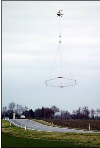
Figur 5.3. SkyTEM – målinger af jordens elektriske modstand fra helikopter.
