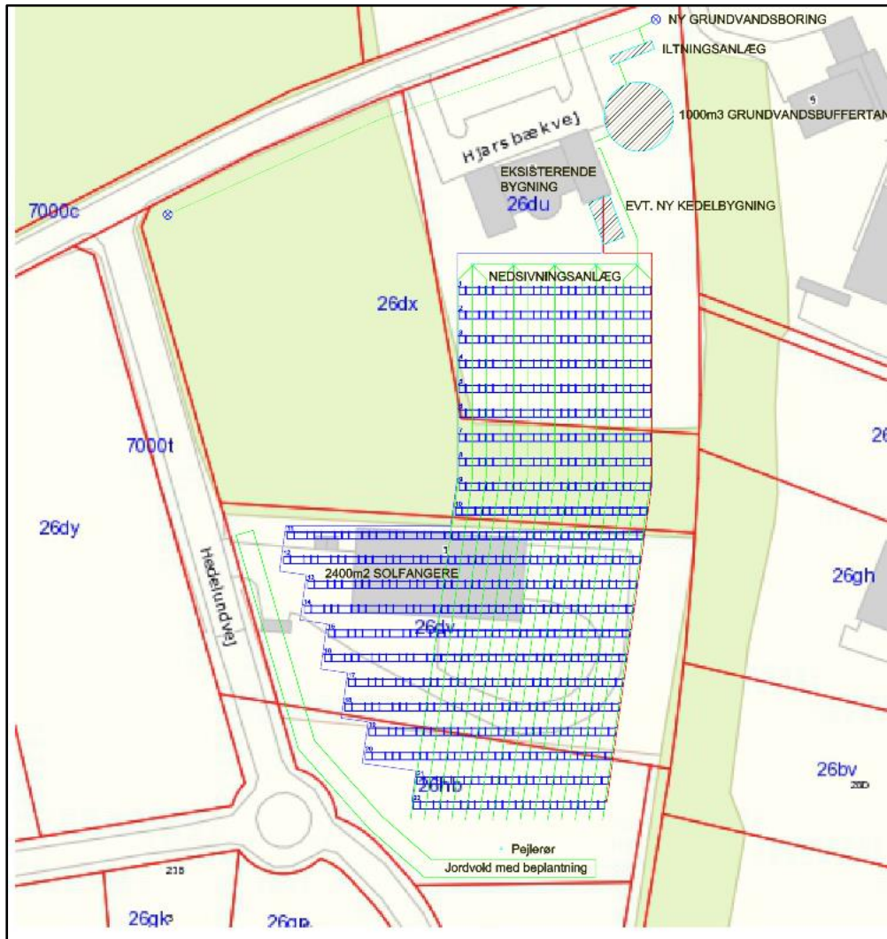
Figur 8.14. Situationsplan med rødt markerede matrikelafgrænsninger. Solfangerfeltet er placeret syd for den eksisterende bygning ned til rundkørslen. Under solfangerfeltet er nedgravet drænrør til drænfeltet. I de to nordlige hjørner af grunden befinder de to pumpeboringer. Øst for bygningen ligger buffertanken og rensningsanlægget.
