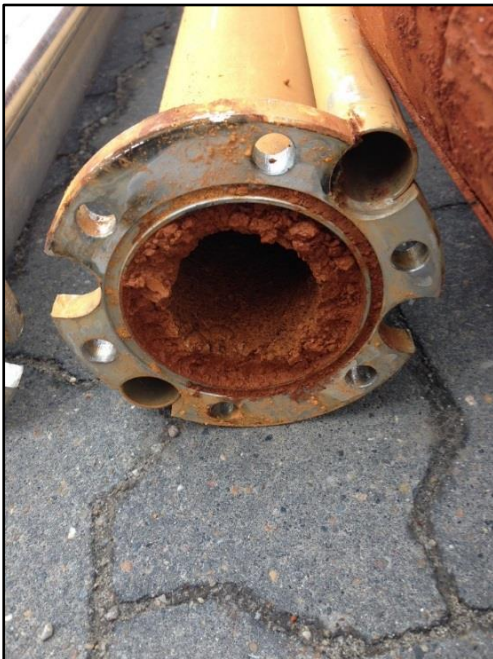
Figur 5.7. Eksempler på pumpe og stigrør fyldt med okker. Foto venligst udlånt af brøndborerfirmaet A. Højfeldt.
