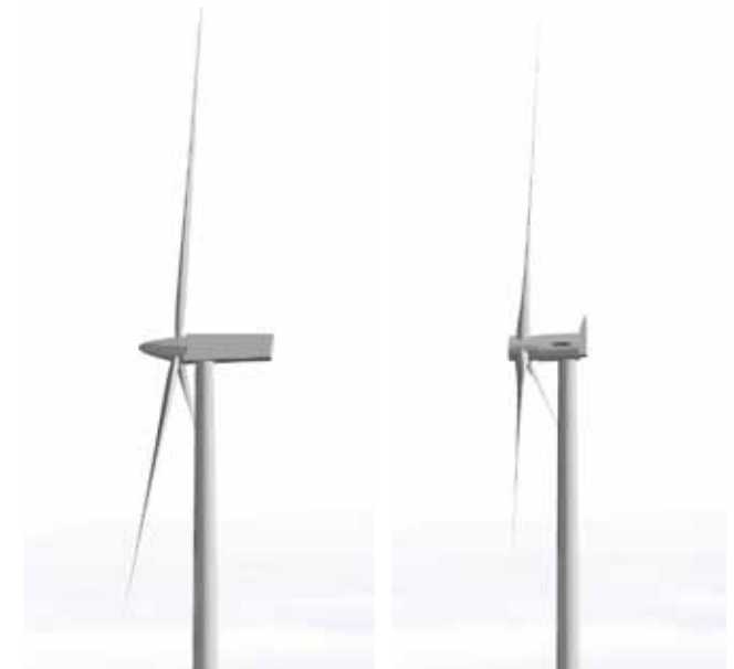
Foto 4.13 Til venstre ses et eksempel på en vindmølle med gear og til højre en vindmølle uden gear. Nacellen uden gear har en lidt anden udformning - den er blandt andet kortere og har en løftet "hale" og ingen "næse" - og dermed et lidt andet udtryk.
