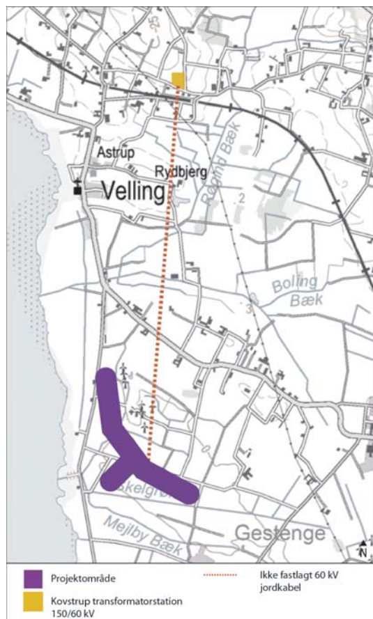
Figur 5.16a: Fremføring af 60 kV jordkabel til 150 kV station Koustrup nord for Velling.
