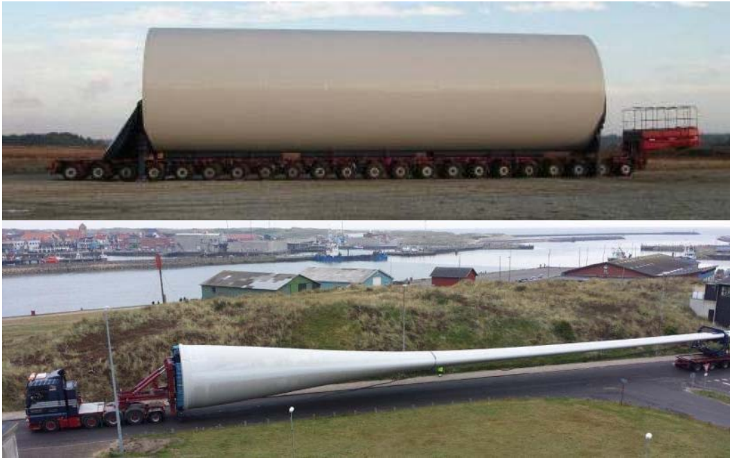
Figur 5.20: Transport af tårndel og vinge til V164 Østerild. Vingen rager 25 meter uden for den bageste lille vogn, som ses længst til højre. Foto: Vestas.
