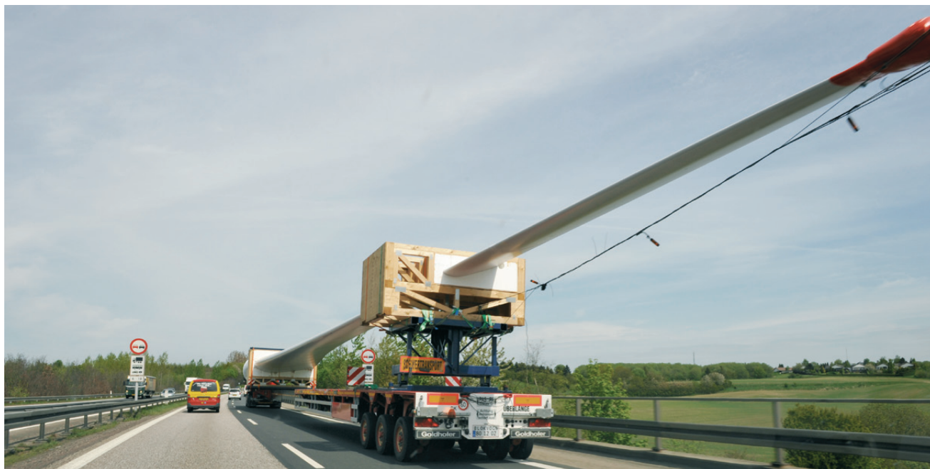
Foto 3.5 Transport af vindmøllevinge på offentlig vej.
